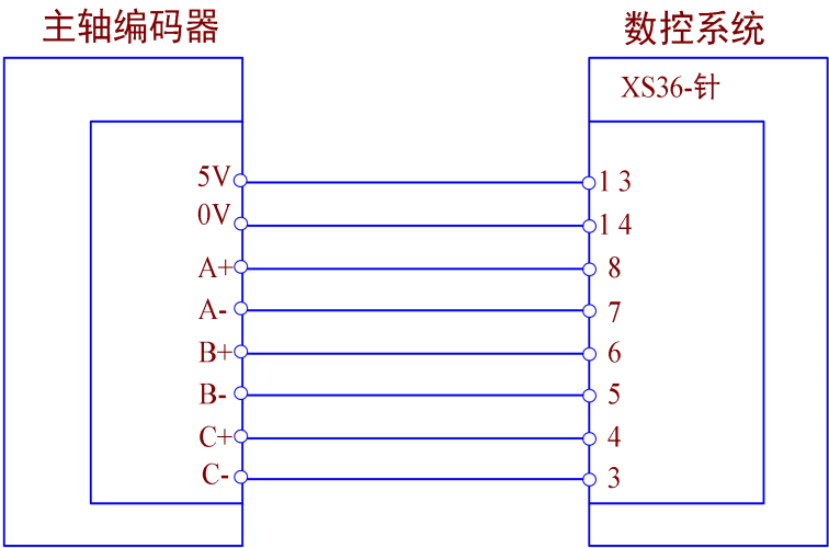
脉冲型伺服主轴接线参考图：
